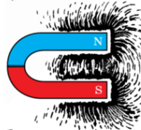
Рис. 127. Магнитные линии поля полосового (а) и дугообразного (б) магнитов
